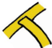
2本の銅テープをつなぎ合わせるには、片方の銅テープの上にもう片方の銅テープを強く押し付け、導電性のある粘着部分をしっかり貼りつけます。そのまま固定したい場合は、銅テープが重なった部分をハンダづけしても良いでしょう。
