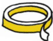
銅テープは銅でできているため、電気を良く通します。裏の粘着部分も、ある程度は電気を通すため、電線のようにつなぎ合わせることもできます。
