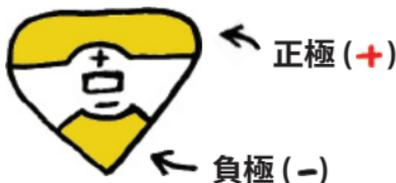
LEDは発光ダイオードの略で、電圧を加えると発光します。LEDシールは「+」から「-」に向けた矢印のような形をしています。平たく広めの金属部分は正極（+）で、先がとがった形をしている金属部分が負極（-）です。
