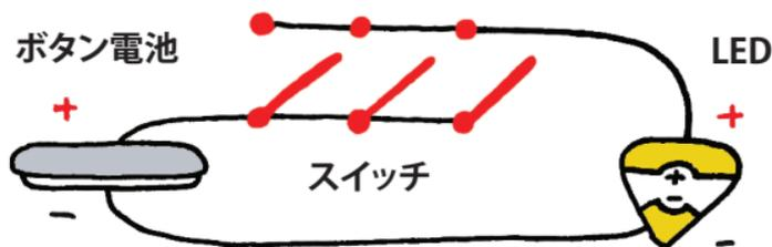
スイッチに沿って指を滑らせると、回路の隙間が開いたり閉じたりして、光が点灯したり消灯したりします。
